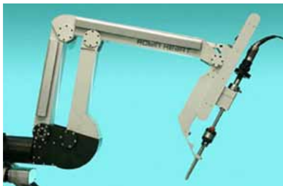
Rys. 3. Elementy zrobotyzowanych stanowisk operacyjnych FRK Zabrze: Robot Robin Heart Vision (u góry), zrobotyzowane narzędzie do obsługi ręcznej lub obsługi przez robota (z lewej)
