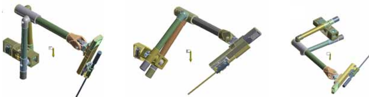
Rys. 14. Wizualizacja przykładowych obciążeń przyjętych do badań symulacyjnych ugięcia pod ciężarem własnym: od lewej: położenie podstawowe, obrót na pierwszym stopniu swobody o kąt 45^\circ , obrót na pierwszym stopniu swobody o kąt 90^\circ .
