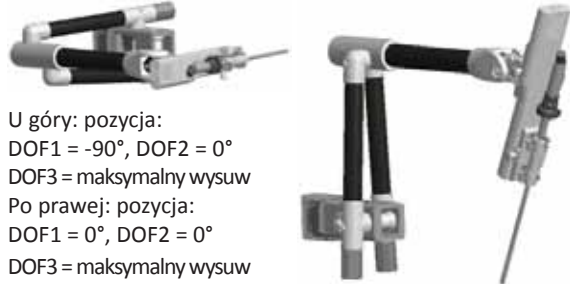
Rys. 7. Położenia manipulatora stosowane podczas analiz statycznych dla pierwszego stopnia swobody.
