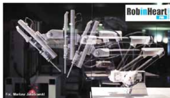
Rys. 4. Postać rzeczywista manipulatora PVA w przykładowych trzech położeniach.
