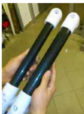
Rys. 3. Elementy konstrukcyjne manipulatora od lewej: a) korpusy wykonane z materiału PC w technologii Rapid Prototyping, b) nogi manipulatora wykonane z kompozytu wzmacnianego włóknem węglowym, c) anodowany korpus wykonany ze stopu aluminium metodą obróbki skrawaniem.
