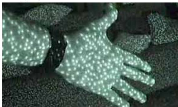
Rys. 7 Ilustracja zasady działania sterownika Kinect.
