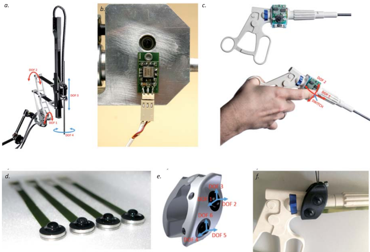
Rys. 8. Prototypy miniaturowych zadajników dedykowanych dla robotów toru wizyjnego: robot Pelikan z zaznaczonymi stopniami swobody (a), zadajnik – wersja urządzenia w oparciu o czujniki żyroskopowe (b), z zastosowaniem manipulatora punktowego (trackpoint) (c), oraz czujnika siły 3D wykonanego w technologii MEM's (projekt INCITE) wykorzystywanego jako mikrodrożystka (d-f)
