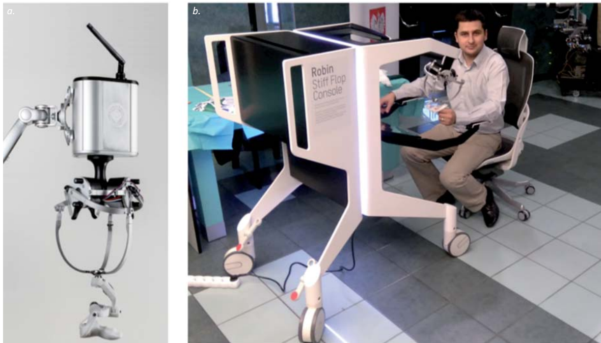
Rys. 7. Zadajnik RobinHand L a) wersja mobilna – komunikacja WiFi, b) konsola sterująca wraz z zaadaptowanym zadajnikiem (projekt Stiff Flap)
