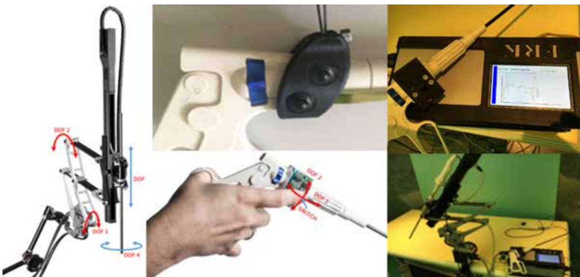
Rysunek 5. Prototypy manipulatora w oparciu o wykonany czujnik siły 4 x 4 mm [17]
