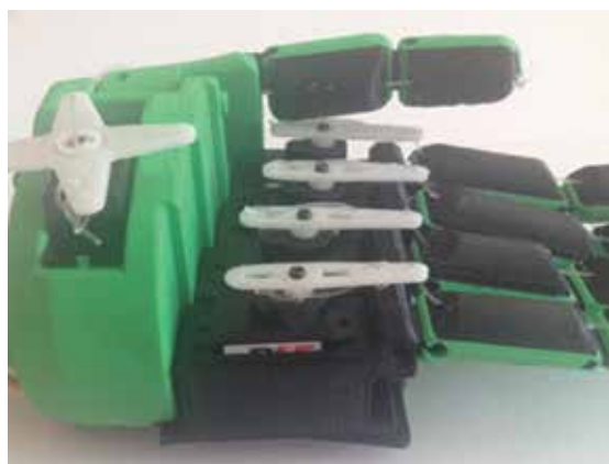
Rysunek 4. Zamocowane żyłki na orczykach
