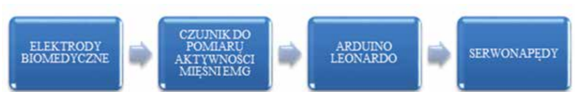
Rysunek 6. Schemat zasady działania protezy dłoni [1]
