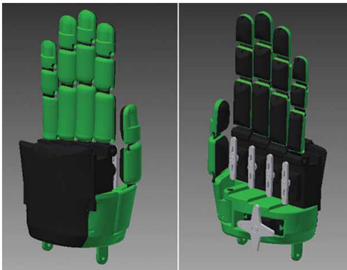
Rysunek 3. Złożenie protezy – widok na zewnętrzną i wewnętrzną część [1]
