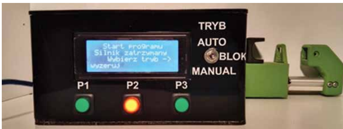
Rysunek 8. Widok gotowego urządzenia do symulacji oporów na oksygenatorze [4]
