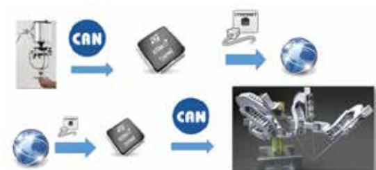
Rysunek 5. Schemat systemu przesyłania sygnałów sterowania robotem z minimalizacją opóźnień
