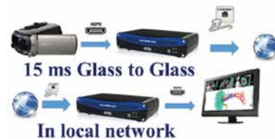
Rysunek 3. Schemat transmisji obrazu z minimalnymi opóźnieniami
