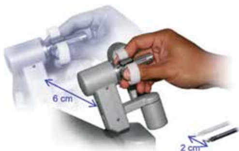
Rycina 6. Skalowanie czułości ręcznych kontrolerów w stosunku do instrumentów. Źródło: https://www.researchgate.net/publication/236044306_Robotic_surgery_in_gynecology
