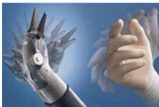
Rycina 2. System EndoWrist® odwzorowujący zakres ruchów dłoni chirurga. Źródło: Palep JH: Robotic assisted minimally invasive surgery. J Minim Access Surg 2009 Jan; 5(1): 1–7. https://www.journalofmas.com/viewimage.asp?img=JMinAccessSurg_2009_5_1_1_51313_u3.jpg
