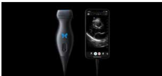
Rysunek 4. Przenośny aparat USG Butterfly IQ, który składa się z głowicy USG podłączanej do telefonu komórkowego https://www.ultrasoundtraining.co.uk/resources/news/should-you-buy-a-butterflyultrasound-machine/ny
