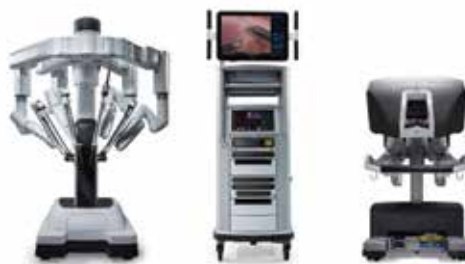
Rycina 1. Trzy elementy systemu robotowego da Vinci: konsola chirurga, wózek pacjenta oraz kolumna z torem wizyjnym. Źródło: https://www.synektik.com.pl/pl/oferta/da-vinci/o-systemie/
