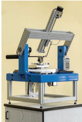
Rysunek 10. Badanie sztywności materiałów testowych: aparatura badawcza i wyniki testu materiałów
